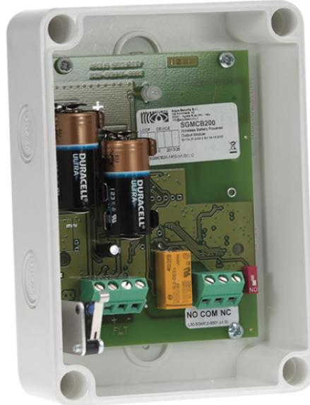
Questo modulo Wireless consente l'attivazione / disattivazione di dispositivi collegati alla sua uscita. Il modulo permette anche il monitoraggio della linea da cortocircuito o interruzione della stessa. Dotato di 2 batterie CR123A una principale ed una di backup. Distanza di comunicazione in campo aperto tra modulo e traslatore/ripetitore fino a 200m. Grado di protezione IP65.
