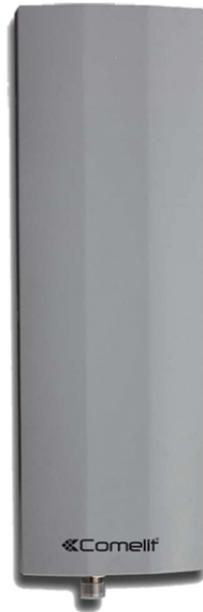
Antenna settoriale 5 GHz, apertura orizzontale 120°, apertura verticale 7° guadagno di 16 dBi, potenza massima 100W, polarizzazione lineare verticale, impedenza 50 ohm, resistenza al vento fino a 160 km/h, connettore tipo N femmina, temperatura di funzionamento da -45°C a +65°C, dimensioni (L x H x P) 175 x 470 x 60 mm.
