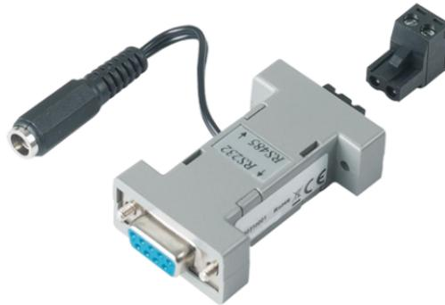
Convertitore attivo di seriale da RS232 a RS485 (brandeggi e telecamere Dome), 1 connettore tipo DB9 per ingresso RS232, 1 connettore tipo morsetti per uscita RS485 (32 ID max), half-duplex, autoconfigurazione Baud Rate, alimentazione 5 VDC (alimentatore in dotazione), contenitore plastico, colore grigio.
