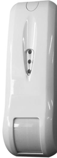
RFDT12CE è un sensore wireless doppia tecnologia a tenda adatto alla protezione di varchi o di pareti con multipli accessi. Con una portata di 12m ed un fascio a tenda con apertura 7.5° offre una copertura ben delimitata che è possibile adattare alle diverse esigenze grazie alla staffa a "L" inclusa. Sono disponibili staffe opzionali da 10 e 15 cm per allontanare il sensore dal muro.
