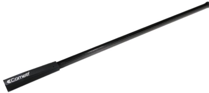
Barriera wireless, attiva ad infrarosso con portata di 5m che garantisce massima efficacia attiva nella rilevazione dell'attraversamento di un varco o di un perimetro grazie all'utilizzo di fasci impulsati costantemente monitorati. Altezza fascia protetta: 2m. Batterie interne al profilo per massima compattezza delle dimensioni. Dimensioni: 40 x 2220 x 40mm.
