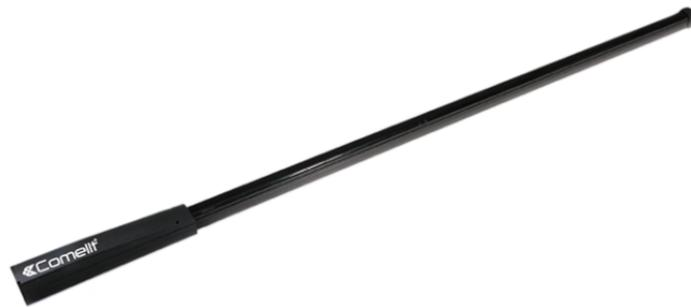
Barriera wireless, attiva ad infrarosso con portata di 5m che garantisce massima efficacia attiva nella rilevazione dell'attraversamento di un varco o di un perimetro grazie all'utilizzo di fasci impulsati costantemente monitorati. Altezza fascia protetta: 1m. Batterie interne al profilo per massima compattezza delle dimensioni. Dimensioni: 40 x 1220 x 40mm.
