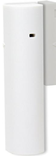
Il contatto magnetico wireless RF1MCW è dotato di un ingresso ausiliario cablato per il collegamento e la trasmissione di una zona indipendente in centrale. Il contatto magnetico è dotato di due ampole reed per un posizionamento flessibile del magnete esterno. Eccellente portata radio e lunga durata delle batterie garantiscono prestazioni costanti nel tempo. Colore bianco.
