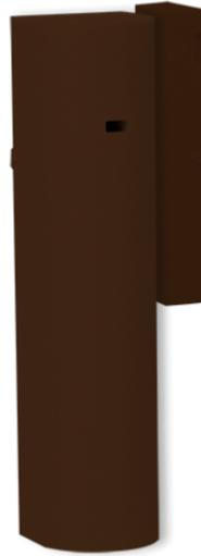
Il contatto magnetico wireless RF1MCB, è dotato di un ingresso ausiliario cablato per il collegamento e la trasmissione di una zona indipendente in centrale. Il contatto magnetico è dotato di due ampole reed per un posizionamento flessibile del magnete esterno. Eccellente portata radio e lunga durata delle batterie garantiscono prestazioni costanti nel tempo. Colore marrone
