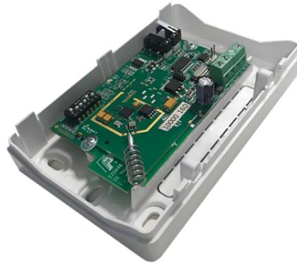
Moduli ricetrasmittitori radio che permettono di utilizzare i dispositivi wireless elencati nelle centrali Comelit della serie VEDO. Permettono l'utilizzo di fino a 10 sensori, 8 sirene e 16 telecomandi radio. Alloggiato in contenitore plastico antifiamma colore bianco completo di tamper antiapertura e anti-strappo escludibili. E' possibile alloggiarlo anche all'interno dei contenitori art. BOXSTANDARD, BOXPLASTIC, BOXMETAL e BOXFLUSH. Dimensioni (L x H x P) 126 x 80 x 32 mm.
