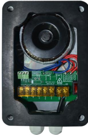
Box di alimentazione, completo di trasformatore e collegamento rapido, per telecamere dome art. AHPTZ122IRA
