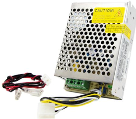
Alimentatore switching Open Frame, caricabatteria PB, ingresso 90÷260 VAC / 50÷60 Hz, uscita 13.8 VDC / 1.5 A. Dimensioni (L x H x P) 110 x 33 x 80 mm. Certificato EN50131-6 grado 2.
