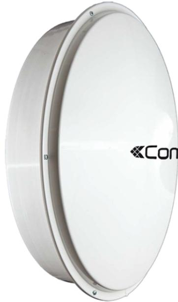
Antenna parabolica 5 GHz, apertura orizzontale 6°, apertura verticale 6° guadagno di 28 dBi, potenza massima 100W, polarizzazione lineare verticale e orizzontale, impedenza 50 ohm, resistenza al vento fino a 200 km/h, connettore tipo N femmina, temperatura di funzionamento da -45°C a +65°C, diametro di 648 mm.
