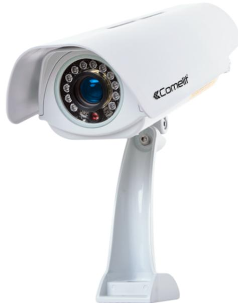
Telecamera lettura automatica delle targhe e merci pericolose su doppia corsia di marcia con video analisi multipla integrata. Sensore OCR 5MP con lente varifocale da 12-40 mm, sensore di contesto Night Vision CMOS con lente a fuoco fisso da 12mm.
