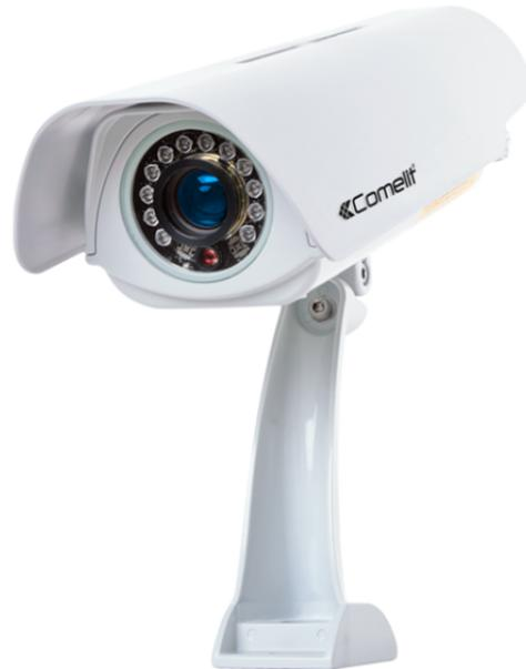
Telecamera lettura targhe e merci pericolose mono corsia con lente fuoco fisso da 35 mm, provvista di sensore aggiuntivo di contesto a colori Night Vision, ad alta sensibilità, da 2 Mpx con lente a fuoco fisso da 12 mm.
