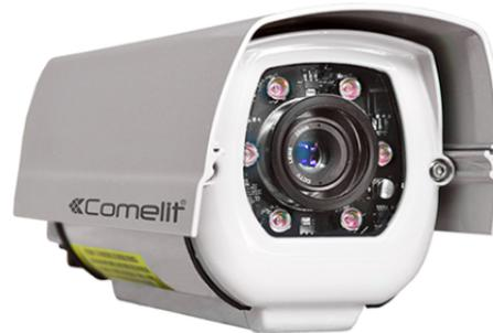
Telecamera IP per lettura targhe all-in-one, ottica fissa da 16 mm, risoluzione FULL-HD@60 ips, contenitore waterproof IP66, 6 illuminatori ad infrarosso ad alta potenza con portata di 10 metri, velocità di rilevamento del transito di 40 km/h senza sincronismi (free flow) con precisione del 95%, velocità massima di rilevamento di 80 km/h.
