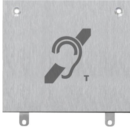
Frontale per Switch a 5 colonne pulsanti con induzione magnetica che permette agli utenti udiolesi di ascoltare la conversazione audio sul posto esterno tramite il proprio apparecchio acustico (dotato di selettore per T-coil). Finitura acciaio inox AISI 316. Dimensioni (L x H x P): 495 x 127.5 x 20mm.
