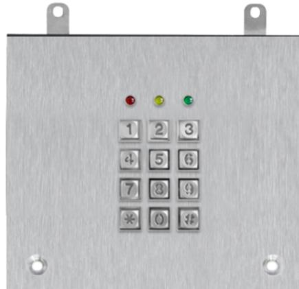
Frontale per Switch a 2 colonne pulsanti con chiave elettronica digitale, retroilluminazione della tastiera a led, finitura in acciaio inox. Consente l'azionamento di serrature elettriche o di altri dispositivi. Dimensioni (L x H): 216.4 x 129.5mm.
