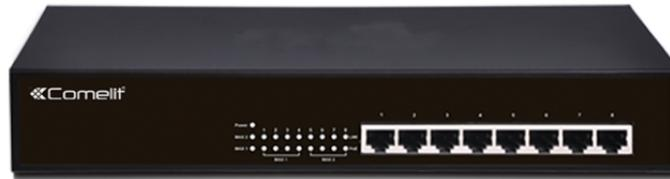
Switch di rete a 8 porte PoE gigabit. Potenza erogata: 30W max per porta, 150W max totali, supporta gli standard PoE IEEE802.3at e IEEE802.3af, conforme allo standard IEEE802.3az per l'efficienza energetica, controllo di flusso IEEE802.3x per la modalità full-duplex e back-pressure per la modalità half-duplex, negoziazione automatica della trasmissione e della velocità, tabella dei MAC address con funzione auto-learning e auto-aging, metodo di trasferimento dei dati store and forward
