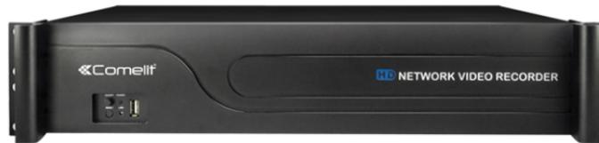
Videoregistratore di rete (NVR) stand-alone per 36 ingressi IP 4K / 5MP / 4MP / 3MP / FULL-HD (1080p) / HD (960p/720p), compatibile ONVIF 2.2.
