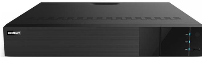
Videoregistratore di rete (NVR) per 16 canali IP (16 PoE), risoluzione max 8MP, compressione video H.265 /H.264, dual streaming, bandwidth 160Mbps. Supporta tutte le funzioni di video analisi DVA delle telecamere connesse. Database volti e targhe. Compatibile con browser: IE/Google Chrome/Edge/Firefox/Safari. Ingressi / uscite allarme. Controllo da remoto tramite APP Comelit CCTV e software Comelit CCTV Manager. Questo NVR si connette ai server di Comelit protetti dai servizi AWS.
