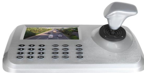
Tastiera di comando IP per il controllo di telecamere PTZ serie 100-700 (escluso tour). Collegamento Plug & Play, menu OSD, numero di telecamere gestibili illimitato, visualizzazione dell'immagine della telecamera selezionata a colori sul monitor 5" in dotazione (1080p max) e sul monitor connesso alla porta HDMI, ricerca automatica/manuale delle telecamere, gestione Preset e Tour (9600bps), porta per connessione mouse, joystick 3D, compatibile ONVIF 2.4. Alimentatore incluso.
