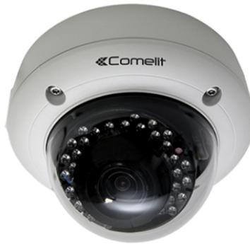
Telecamera IP minidome a colori Day & Night, ottica motorizzata varifocale da 2.8-12 mm con funzione Smart Focus, risoluzione 3 MegaPixel@30 ips, contenitore waterproof IP66, 36 illuminatori ad infrarosso con portata di 35 metri, compatibile ONVIF 2.4.
