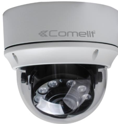
Telecamera IP minidome a colori Day & Night, ottica motorizzata varifocal da 2.8-12 mm con funzione autofocus, risoluzione 3MP@30 ips, contenitore waterproof IP66 antivandalo, 6 illuminatori ad infrarosso IR-III con portata di 30 metri (Smart IR), regolazione del gruppo telecamera su 3 assi, compatibile ONVIF 2.2.
