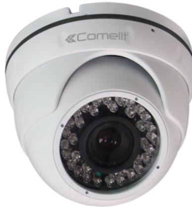
Telecamera IP minidome a colori Day & Night, ottica fissa da 3.6 mm, risoluzione FULL-HD (1080p)@30 ips, contenitore waterproof IP65, 36 illuminatori ad infrarosso con portata di 15 metri, compatibile ONVIF 2.2.
