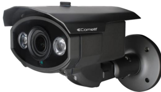
Telecamera IP all-in-one a colori Day & Night, ottica motorizzata varifocal da 3.6-10 mm con funzione autofocus, risoluzione 5MP@30 ips, contenitore waterproof IP66, 2 led array ad infrarosso con portata di 50 metri, compatibile ONVIF 2.2.
