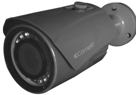
Telecamera IP bullet a colori Day & Night, ottica motorizzata varifocal da 2.8-8 mm con funzione autofocus, risoluzione 4MP@30 ips, contenitore waterproof IP66, 15 led SMD ad infrarosso con portata di 30 metri (SMART IR), compatibile ONVIF 2.2.
