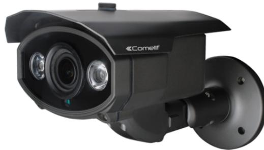
Telecamera IP bullet a colori Day & Night, ottica varifocal motorizzata da 2.8-12 mm, risoluzione 3MP@30 ips, contenitore waterproof IP66, 2 led array ad infrarosso con portata di 50 metri, compatibile ONVIF 2.2.
