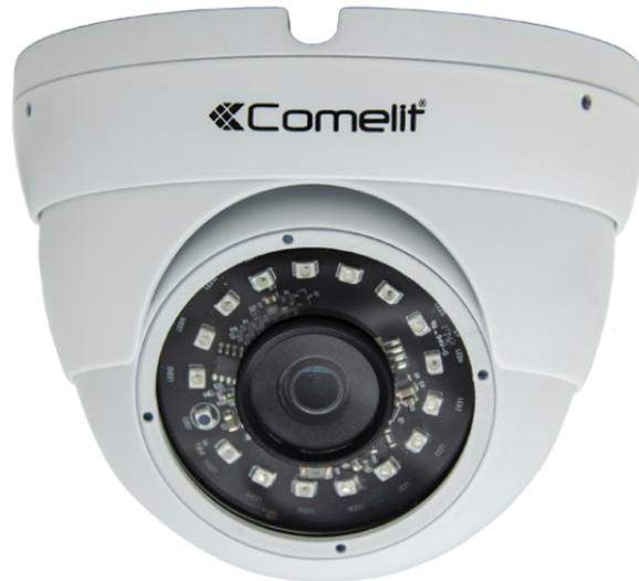
Telecamera IP minidome a colori Day & Night, ottica fissa da 3.6 mm, risoluzione 4MP@30 ips, contenitore waterproof IP66, 16 illuminatori ad infrarosso SMD con portata di 30 metri (SMART IR), compatibile ONVIF 2.2.
