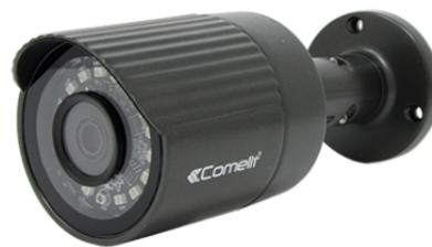
Telecamera IP all-in-one a colori Day & Night, ottica fissa da 3.6 mm, risoluzione FULL-HD (1080p)@30 ips, contenitore waterproof IP66, 16 illuminatori ad infrarosso SMD con portata di 15 metri, compatibile ONVIF 2.2.
