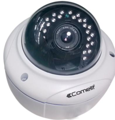
Telecamera IP minidome a colori Day & Night, ottica varifocal da 2.8-12 mm, risoluzione FULL-HD (1080p)@30 ips, 30 illuminatori ad infrarosso con portata di 30 metri, regolazione del gruppo telecamera su 3 assi, compatibile ONVIF 2.4.
