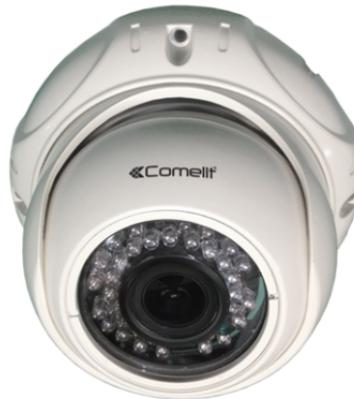
Telecamera IP minidome a colori Day & Night, ottica fissa da 3.6 mm, risoluzione FULL-HD (1080p)@30 ips, 36 illuminatori ad infrarosso con portata di 30 metri, compatibile ONVIF 2.4.
