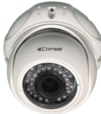
Telecamera IP minidome a colori Day & Night, ottica fissa da 3.6 mm, risoluzione HD (720p)@30 ips, 36 illuminatori ad infrarosso con portata di 30 metri, compatibile ONVIF 2.4.
