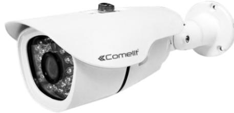
Telecamera IP all-in-one a colori Day & Night, ottica motorizzata varifocal da 2.8-12 mm con funzione autofocus, risoluzione 4MP@30 ips, contenitore waterproof IP66, 28 illuminatori ad infrarosso con portata di 25 metri, compatibile ONVIF 2.4.
