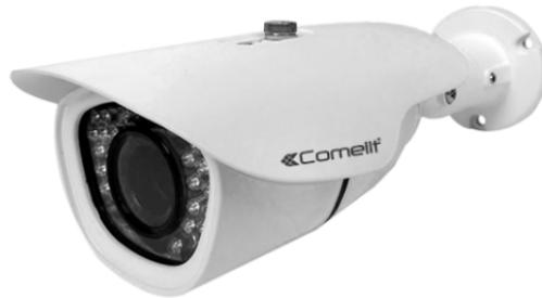
Telecamera IP all-in-one a colori Day & Night, ottica fissa da 3.6 mm, risoluzione 4MP@30 ips, contenitore waterproof IP66, 30 illuminatori ad infrarosso con portata di 30 metri, compatibile ONVIF 2.4.
