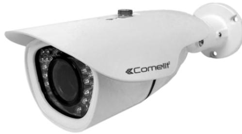
Telecamera IP bullet a colori Day & Night, ottica fissa da 3.6 mm, risoluzione FULL-HD (1080p)@30 ips, contenitore waterproof IP66, 30 illuminatori ad infrarosso con portata di 30 metri, compatibile ONVIF 2.4.
