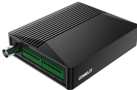
Video server IP / espansione allarmi compatibile con AHDVR/NVR serie Next e Advance. 8 ingressi / 4 uscite allarme. Ingresso analogico max 5MP (cavo con lunghezza fino a 200 metri), analisi video (risoluzione minima 2MP, fino ad una distanza di 5 metri), slot micro SD card.
