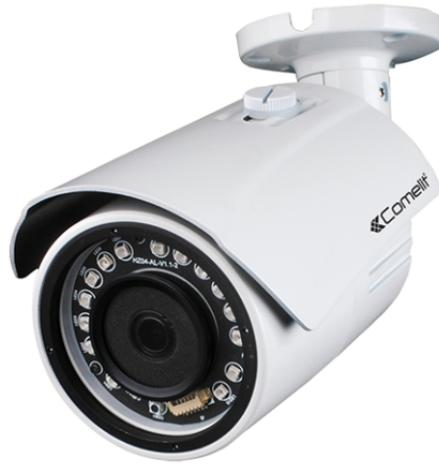
Telecamera IP bullet a colori Day & Night, ottica motorizzata varifocal da 2.8-8 mm con funzione autofocus, risoluzione 4MP@30 ips, contenitore waterproof IP66, 15 led SMD ad infrarosso con portata di 30 metri (SMART IR), compatibile ONVIF 2.2.
