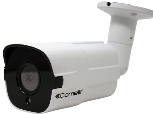
Telecamera IP all-in-one a colori Day & Night, ottica varifocal da 2.8-12 mm, risoluzione FULL-HD (1080p)@30 ips, contenitore waterproof IP66, 28 illuminatori ad infrarosso con portata di 25 metri, compatibile ONVIF 2.4.
