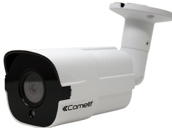
Telecamera IP bullet a colori Day & Night, ottica fissa da 3.6 mm, risoluzione FULL-HD (1080p)@30 ips, contenitore waterproof IP66, 30 illuminatori ad infrarosso con portata di 30 metri, compatibile ONVIF 2.4.
