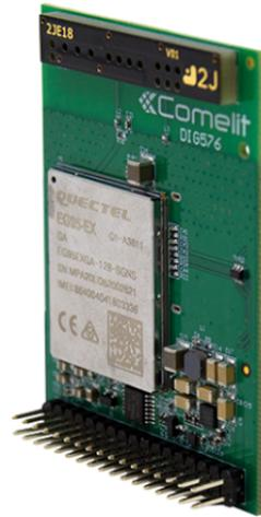
HUB4G è il modulo GSM/GPRS/3G/4G ad innesto che permette di abilitare la centrale Secur Hub all'invio di telefonate ed SMS. Il modulo si connette inoltre al cloud Comelit e permette l'invio di e-mail e notifiche push. Il modulo può essere utilizzato anche per gestire la centrale da app Comelit con eccellente responsività, in qualità di vettore principale o secondario nel caso sia disponibile la connettività Wi-Fi o LAN. HUB4G può inoltre veicolare il video proveniente dalla centrale.
