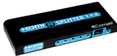
Distributore di segnale HDMI, 1 ingresso / 4 uscite in contemporanea. Compatibile con standard HDMI 1.2 e HDCP. 1.65 Gbps per canale. Alimentatore in dotazione.
