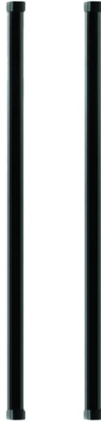
Coppia di barriere all'infrarosso, 4 raggi doppi, per impiego in ambienti interni o esterni, altezza 1,5 m. Portata massima 15 m in esterno (min. 20 cm). Tensione di alimentazione 12 VDC, assorbimento 86 mA, grado di protezione IP54. Dimensioni (L x H x P): 30 x 1500 x 30mm, colore nero.
