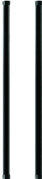
Coppia di barriere all'infrarosso, 3 raggi doppi, per impiego in ambienti interni o esterni, altezza 1 m. Portata massima 15 m in esterno (min. 20 cm). Tensione di alimentazione 12 VDC, assorbimento 78 mA, grado di protezione IP54. Dimensioni (L x H x P): 30 x 1000 x 30mm, colore nero.
