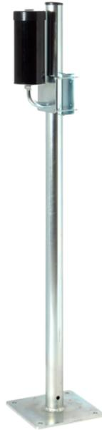
Coppia di sensori a microonda planare di dimensioni ultra compatte. Tensione di alimentazione 12Vdc. Corrente assorbita durante il normale funzionamento 70mA (Tx) / 110mA (Rx). Portata massima 200m. Angolo di allineamento verticale 5°. Angolo di allineamento orizzontale 180°. Apertura lobo super ristretta. 250 frequenze selezionabili per una migliore immunità ai disturbi.
