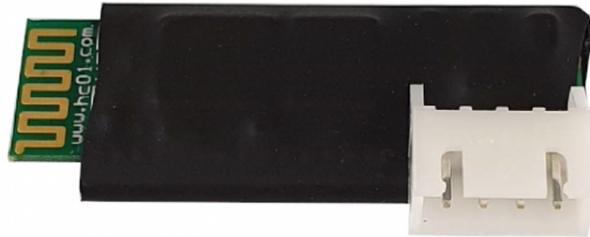
BLTMOD è il modulo BT che consente, attraverso la app Comelit Sensor, la configurazione e la lettura in tempo reale della rilevazione dei sensori compatibili. E' possibile spostare il modulo di sensore in sensore per modificare attraverso smartphone Android la portata, le impostazioni e per verificare la reale copertura del sensore. Sensori compatibili: RFDT12CEB, RFDT12E, RFDP12E, DT12ECAMB, IR180EAMB.
