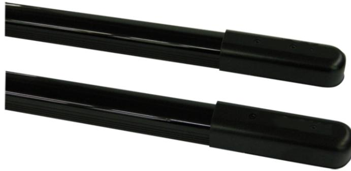
Coppia di barriere all'infrarosso, 6 raggi doppi, per impiego in ambienti interni o esterni, altezza 2 m. Portata 20 m (interno), 10 m (esterno). Tensione di alimentazione 12 VDC, consumo 0.96 W, grado di protezione IP54. Dimensioni (L x H x P): 25 x 2000 x 22 mm, colore nero.
