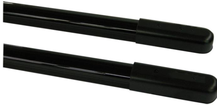
Coppia di barriere all'infrarosso, 4 raggi doppi, per impiego in ambienti interni o esterni, altezza 1.5 m. Portata 20 m (interno), 10 m (esterno). Tensione di alimentazione 12 VDC, consumo 0.6 W, grado di protezione IP54. Dimensioni (L x H x P): 25 x 1500 x 22 mm, colore nero.
