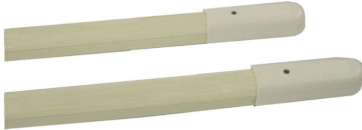
Coppia di barriere all'infrarosso, 3 raggi doppi, per impiego in ambienti interni o esterni, altezza 1 m. Portata 5 m (interno e esterno). Tensione di alimentazione 12 VDC, consumo 0.6 W, grado di protezione IP54. Dimensioni (L x H x P): 25 x 1000 x 22 mm, colore bianco.
