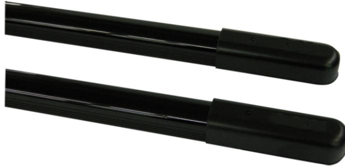
Coppia di barriere all'infrarosso, 3 raggi doppi, per impiego in ambienti interni o esterni, altezza 1 m. Portata 20 m (interno), 10 m (esterno). Tensione di alimentazione 12 VDC, consumo 0.6 W, grado di protezione IP54. Dimensioni (L x H x P): 25 x 1000 x 22 mm, colore nero.
