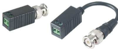
Kit passivo di conversione del segnale video AHD/TVI/CVI su cavo CAT5/UTP e viceversa, connettori tipo BNC per ingresso/uscita del segnale video, terminali a vite per il collegamento del cavo CAT5/UTP, distanza raggiungibile 200 m (HD) o 120 m (FULL-HD) o 100 m(3MP/4MP/5MP), contenitori plastici, colore nero.
